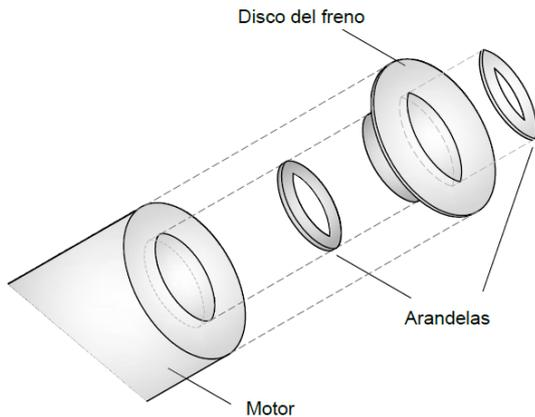
Tenga en cuenta que el disco de freno **no debe** rozar con el motor, puesto que podrían producir un mal funcionamiento del freno, en el caso que pruebe a poner el disco de freno y roce con el motor, ponga arandelas entre medio (tal y como se muestra en la imagen superior) para hacer tope y crear un espacio entre el disco de freno y el motor, y encima del disco del motor, debe insertar otra arandela.
