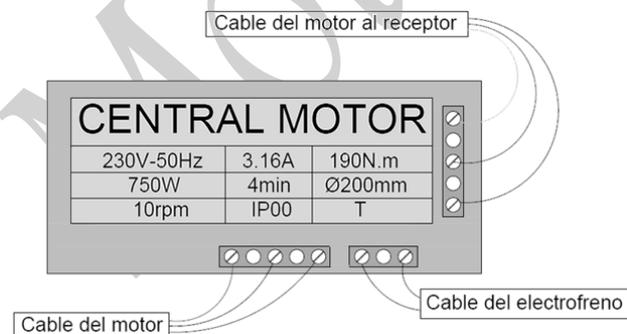
Deberá sustituir el puente del conexionado básico, insertando los dos cables del electrofreno (no importa cual va en cada uno) para así poder realizar la función del mismo. Se recomienda (tal y como se muestra en la siguiente imagen) introducir el cable del electrofreno en la goma de los demás cables.
