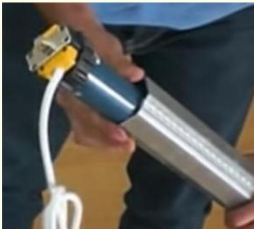
Si el diámetro del motor no se corresponde con el diámetro del eje correspondiente, será necesario que sustituya el motor en cuestión, el adaptador y corona, o bien el eje, según sea necesario.
