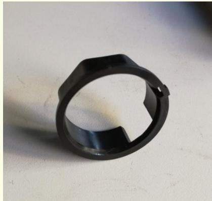
La corona se coloca cerca del cabezal del motor, con cuidado de no dañar las pestañas de la corona del motor y colocando la corona en su debida posición.
