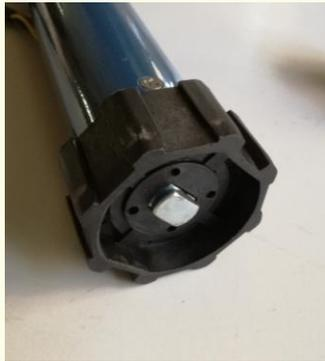
Como podemos comprobar, el adaptador se coloca correctamente en el motor, quedando el diámetro del mismo por encima del diámetro tubular del motor.
