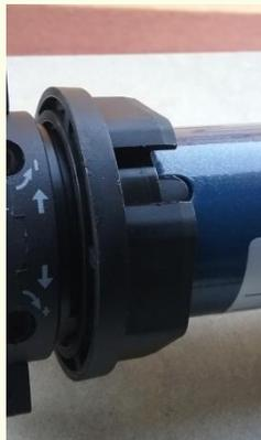
Como podemos observar la corona se coloca correctamente en el cabezal del motor para que pueda funcionar correctamente.
