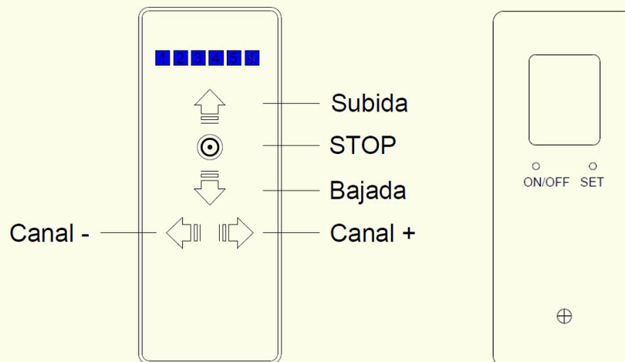
Subida: Utilizado para ordenar el movimiento de subida del motor.
